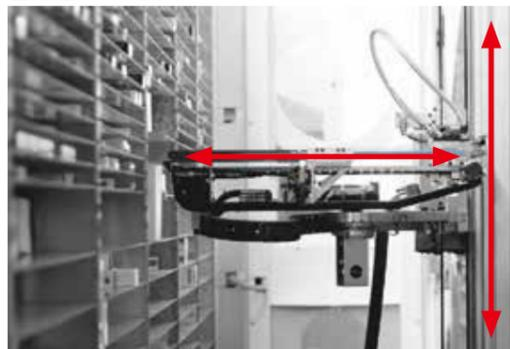
静音走行が可能で室内で使用する装置、機器に適します。無潤滑走行が可能ですので、潤滑剤漏れにより製品を汚す心配がありません。
